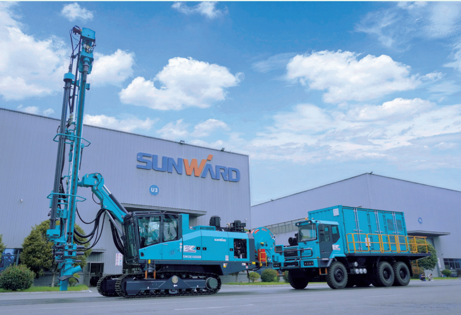
山河矿岩研究院自主研发的 SWDE165EB 电动潜孔钻机，搭载节能控制算法，可实时动态调节油泵电机与空压机电机输出功率
